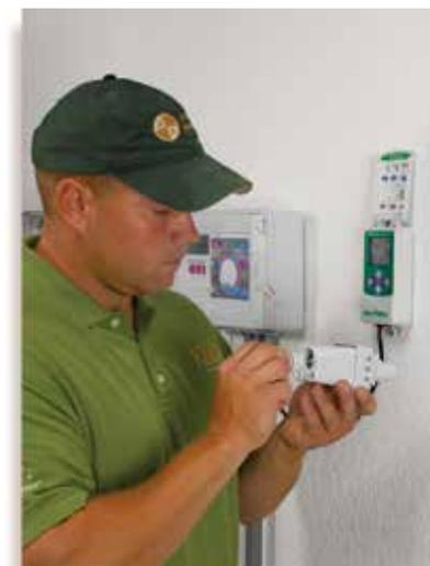
Der Batterieaustausch erfordert keinerlei Werkzeug oder die Demontage des Sensors
