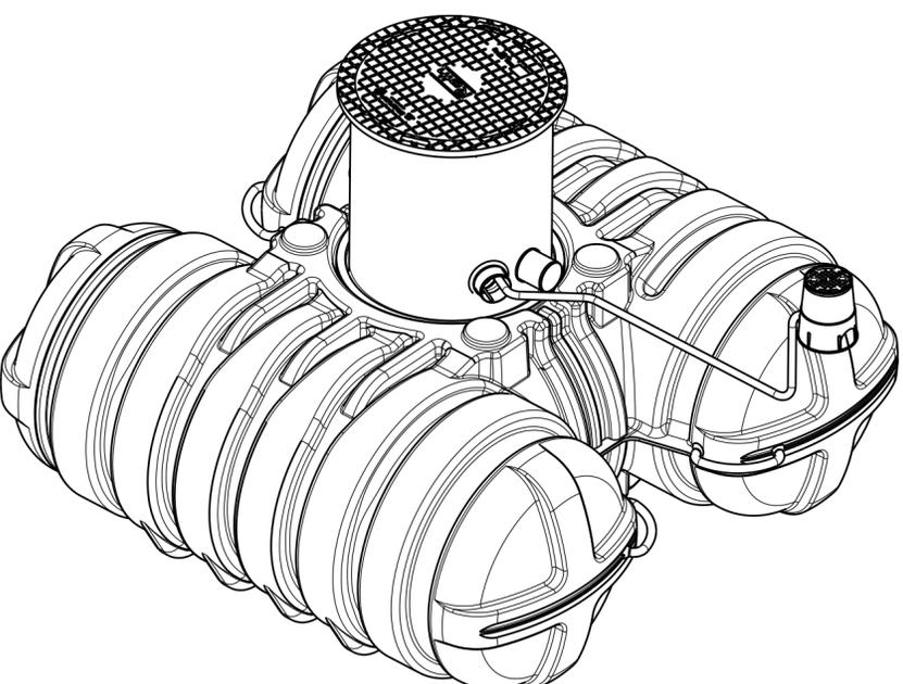
Stutzen DN 110 für Rohr- und Kabeldurchführung mit Spezialdichtung DN 110 (DN 100)
